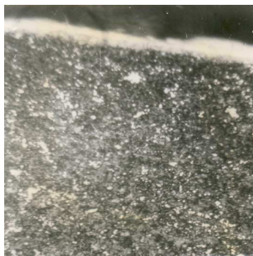
Рис. 2. Микроструктура поверхностного слоя легированной стали после нанесения износостойкого покрытия (электрод – твердый сплав) \times 500 : a – мягкий режим; б – грубый режим
