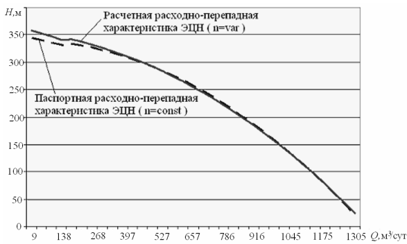
Рис. 4.2. Паспортная и расчетная расходно-перепадные характеристики
