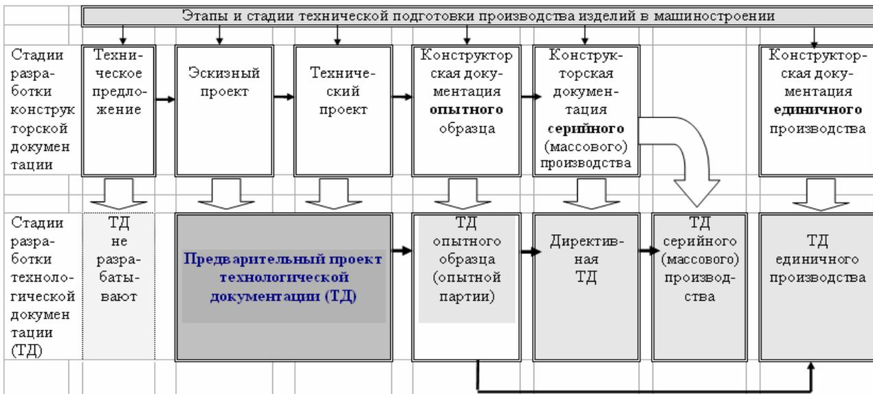
Рис. 1. Схема взаимосвязей разработки конструкторской и технологической документации по ЕСКД и ЕСТД
