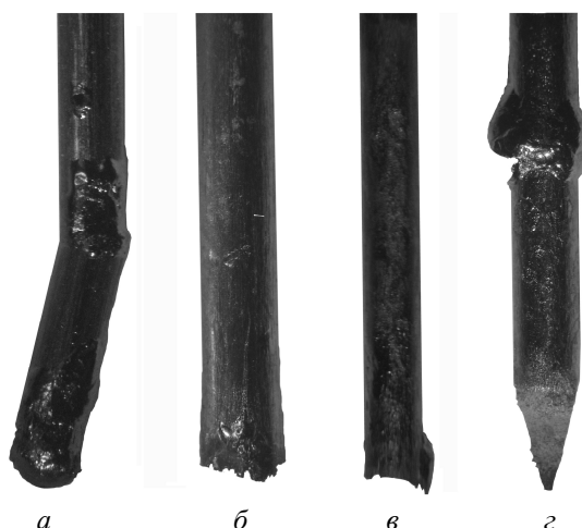
Рис. 4. Электроды после разрушения: а – диаметр 1,0 мм, сила тока 109 А; б – диаметр 1,6 мм, сила тока 194 А; в – диаметр 2,0 мм, сила тока 275 А; г – диаметр 2,0 мм, сила тока 274 А
