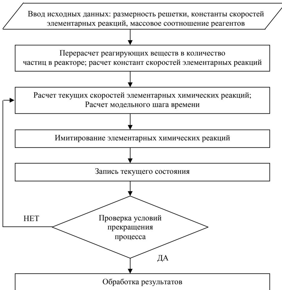
Рис. 1. Схематическое представление модельного процесса полимеризации
