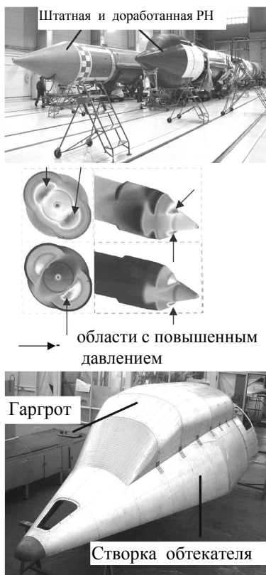
Рис. 3. Доработанная МРН в части введения гаргротов на обтекателе
