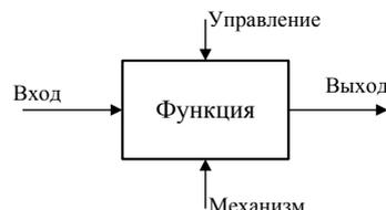
Рис. 2. Функциональный блок (Activity Box)
