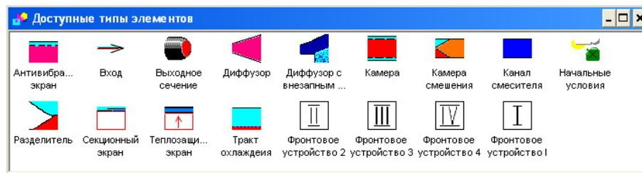
Рис. 14. Библиотека элементов подсистемы «Газодинамика и тепловое состояние»
