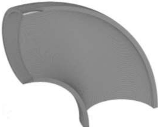
Рис. 6. Гибридная сетка КЭ гiba с учетом трещины
