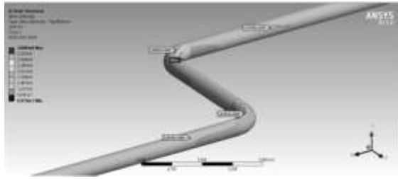
Рис. 5. Поля напряжений в гibe технологического трубопровода при действии эксплуатационных нагрузок ( \sigma_{eqv} = 299,5 МПа)
