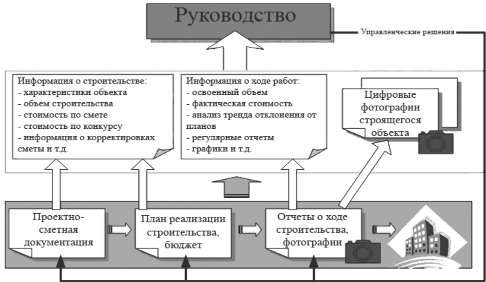
Рис. 7. Схема информационных потоков системы управления проектами
