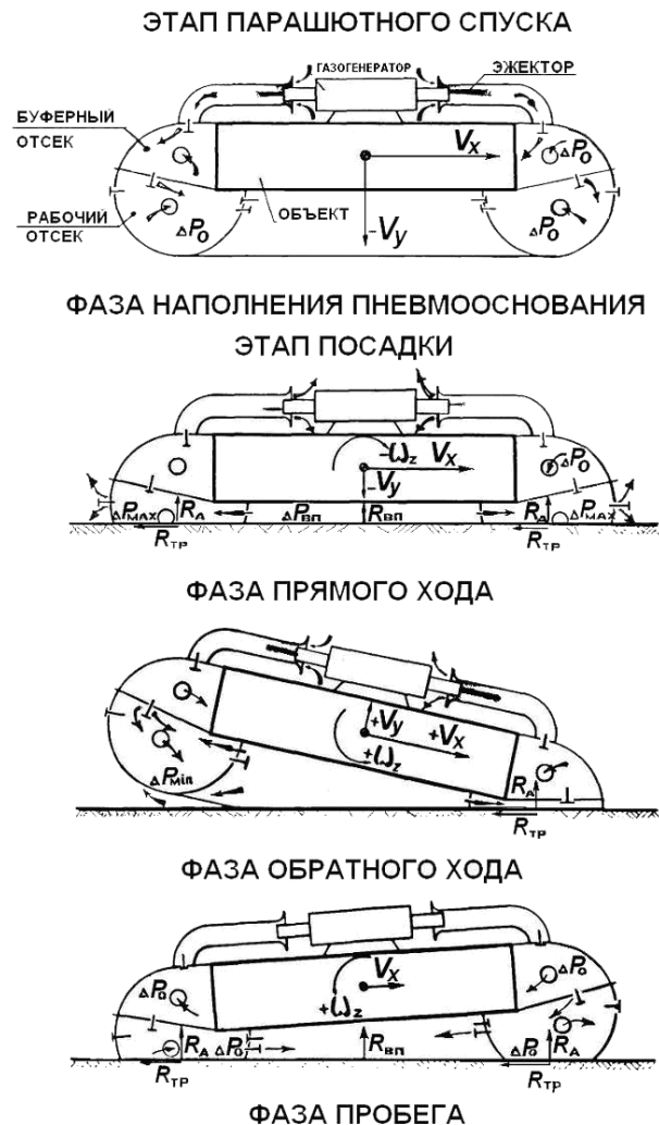
Рис. 12. Фазы посадки спускаемых пневмоупругих систем
