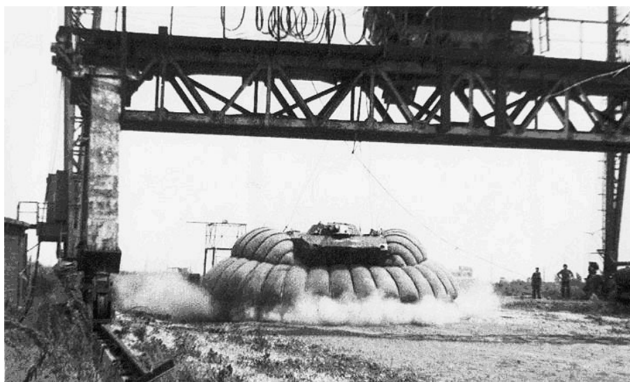
Рис. 8. Пробег спускаемой пневмоупругой системы по площадке приземления
