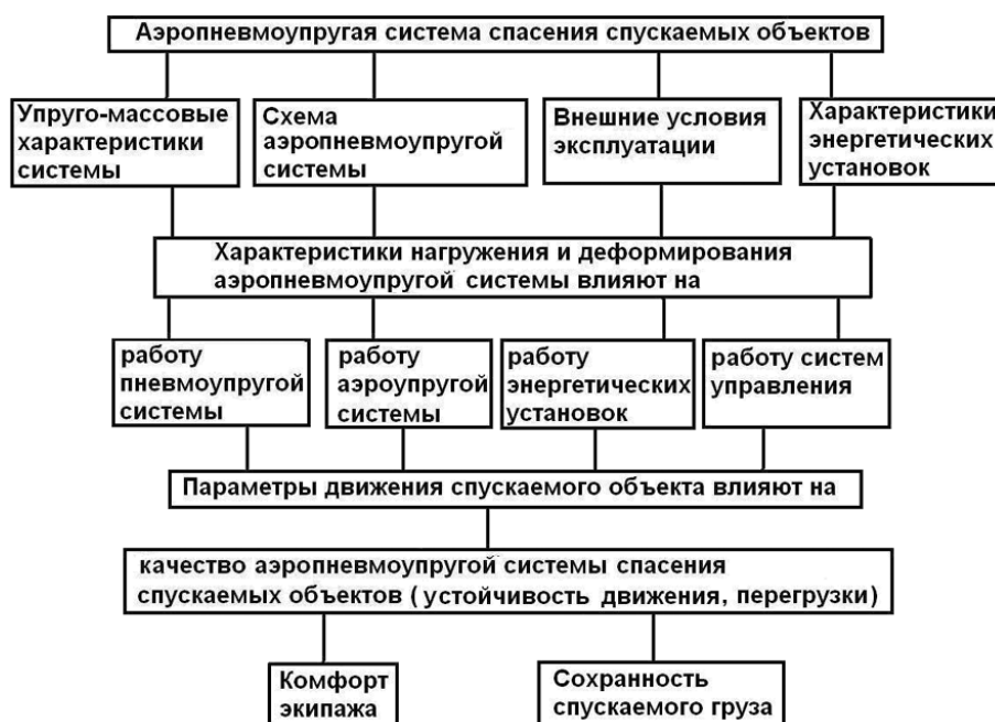
Рис. 2. Характеристика проблемы аэропневмоупругости средства спасения спускаемых систем
