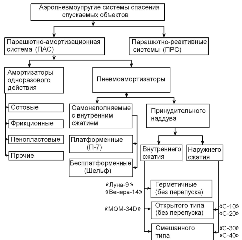
Рис. 3. Классификация спускаемых аэропневмоупругих систем
