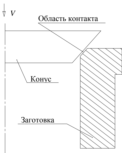
Рис. 2. Область контакта конуса с заготовкой
