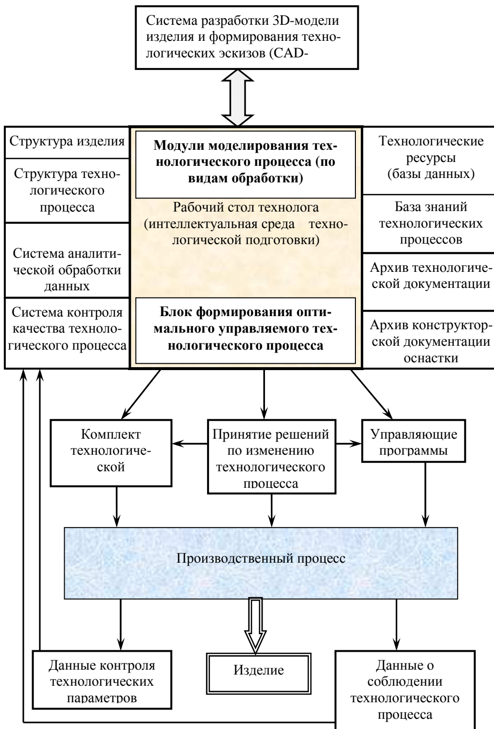
Рис.1. Схема взаимодействия интеллектуальной программной среды технологической подготовки с производственным процессом
