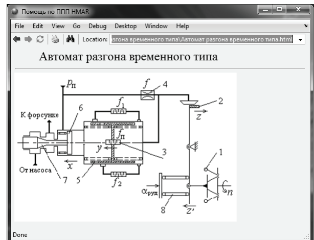
Рис. 29. Окно «Принципиальная схема регулятора»
