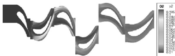
**Рис. 13.** Поле концентрации кислорода в случае моделирования теплоподвода через выходную кромку соплового аппарата [10]
