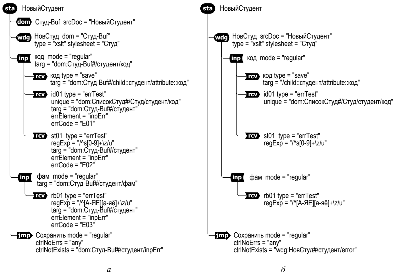
Рис. 6. К использованию правил умолчания при задании DOM-объектов в контролёрах: а – без использования; б – с использованием
