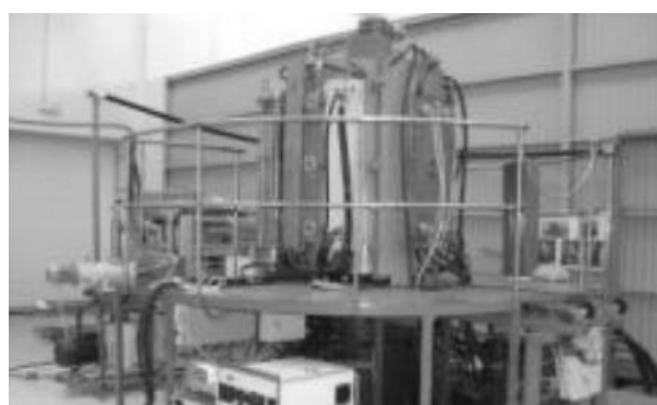
Рис. 10. «Виктория-2» – комплексная система реализации гибридных технологий ионно-лучевой и плазменной модификации поверхностных слоев материала
