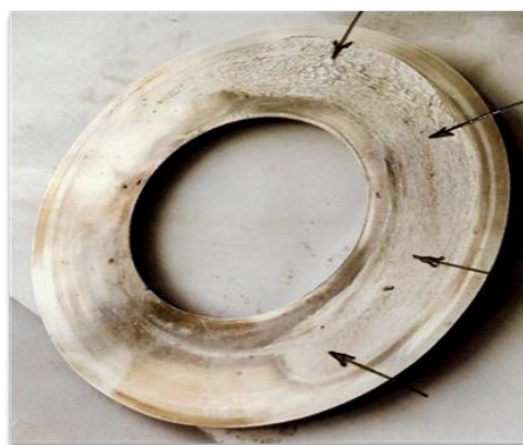
Рис. 1. Характерные неисправности топливного агрегата авиационного ГТД: а – износ упора (практически полностью отсутствует износостойчивое покрытие); б – следы изнашивания графитного кольца в торцевом уплотнении; в – износ всех башмаков на плунжерах; г – глубокая выработка на опорной шайбе
