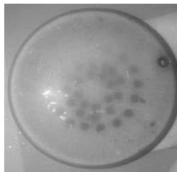
Рис. 2. Внешний вид образца после островкового азотирования
