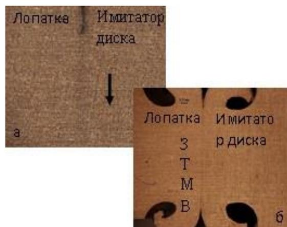
Рис. 4. Макроструктура образца лопатки со стороны грата:
