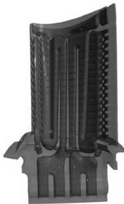
Рис. 2. Внутренние каналы рабочей лопатки газовой турбины
