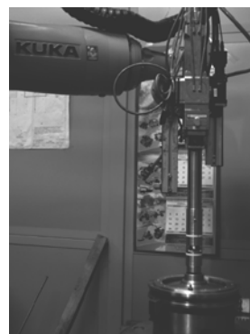
Рис. 10. Установка сварочной головки и центровка «пилотным» лазером
