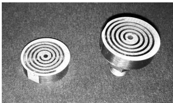
Рис. 10. Заготовки после электроэрозионной обработки
