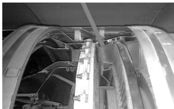
Рис. 3. Место расположения датчиков в поясе первого соплового аппарата турбины низкого давления
