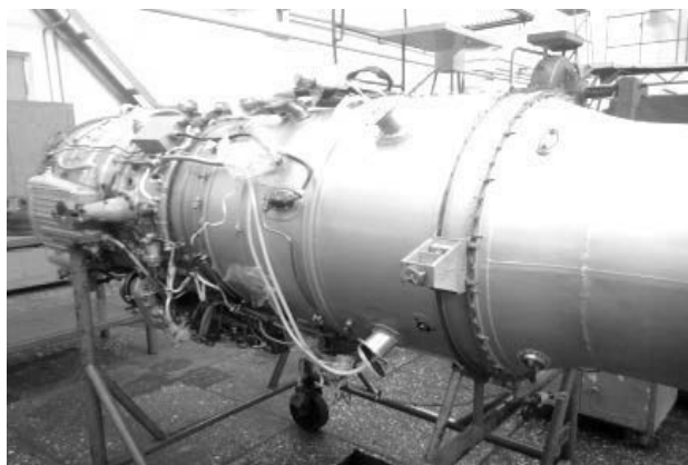
Рис. 2. Объект испытаний, препарированный датчиками пульсаций
