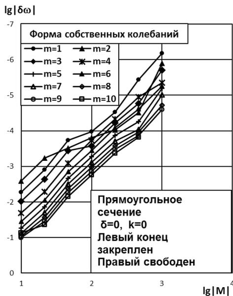
Рис. 2. Погрешность расчета собственных частот стержня постоянного поперечного сечения
