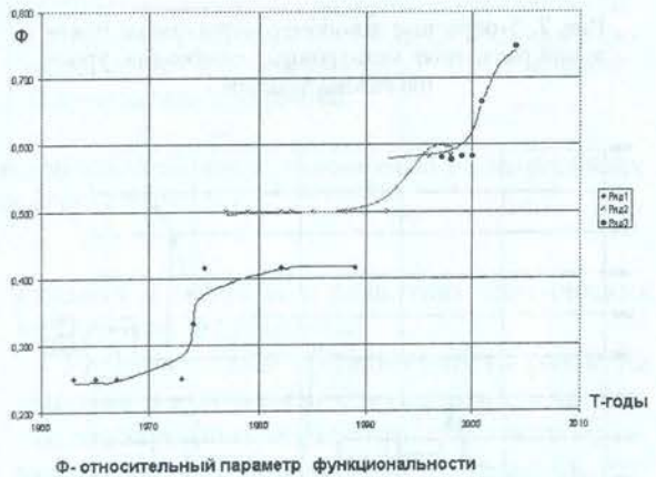
Рис. 6. S-образные закономерности смены поколений расточных мехатронных станков по показателю относительной функциональности
