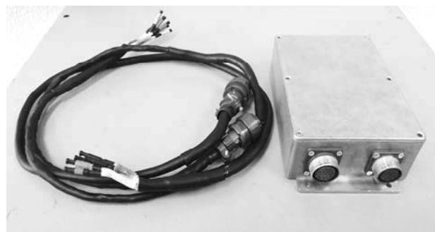
Рис. 8. Внешний вид электронного блока управления и диагностики TP3-117
