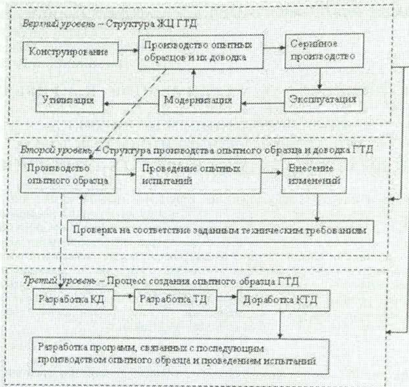
Рис. 1. Структура модели ЖЦ ГТД
