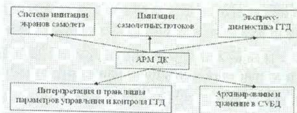
Рис. 5. Функциональная структура АРМ ДК для ГТД на этапе испытания
