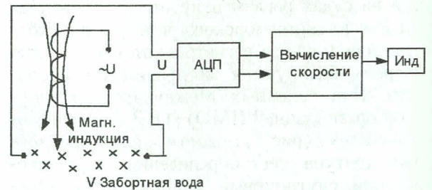
Рис. 2. Структурная схема измерения скорости
