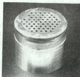
Рис. 2. Стабилизирующая решетка сотовой схемы: 1 — канал подвода топлива, 19 шт; 2 — канал подвода воздуха, 42 шт; 3 — жаровая труба; 4 — фронт пламени
