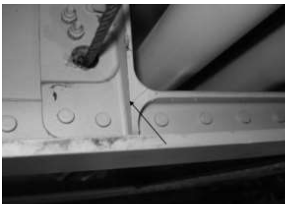
Рис. 1. Трещины шпангоутов ЦЧФ в окнах вырезов под проводку управления:
