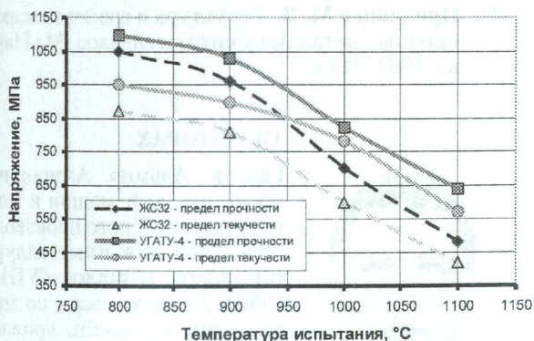
Рис. 3. Средние показатели механических свойств исследованных сплавов в зависимости от температуры испытания
