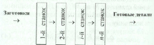
Рис. 3. Модель планировки оборудования при поточном производстве
