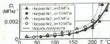
Рис. 25. Расчетная зависимость податливости D = D(T) по модели ползучести стеклопластика КТ-11-К-Ф в сравнении с экспериментом при 20 \leq T \leq 250^\circ\text{C}
