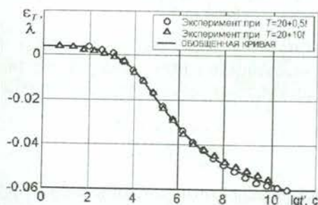
Рис. 6. Тепловая деформация \varepsilon_T стеклопластика КТ-11-К-Ф в зависимости от логарифма условного времени \lg t' (символы). Обобщенная кривая теплового деформирования \lambda(t') (линия)
