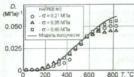
Рис. 26. Расчетная зависимость податливости D = D(T) по модели ползучести стеклопластика КТ-11-К-Ф в сравнении с экспериментом при 200 \leq T \leq 850^\circ\text{C}
