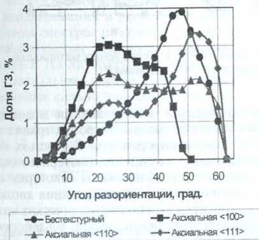
Рис. 2. Распределение углов разориентировок в модельном поликристалле
