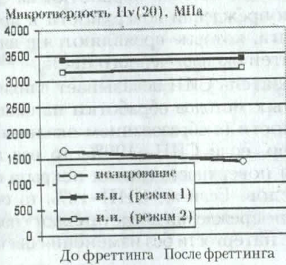
Рис. 8. Изменение микротвердости поверхности в результате фреттинга образцов из сплава ВТ6
