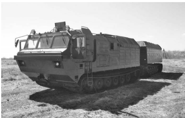
Рис. 7. Двухзвенная сочлененная гусеничная машина амфибия ДТ-30П
