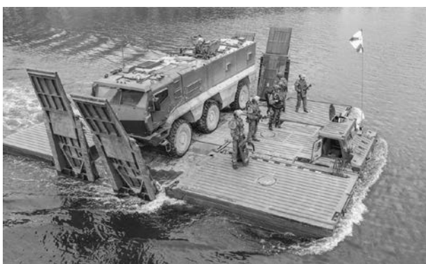
Рис. 3. Транспортировка техники на самоходном пароме ПММ-2М
