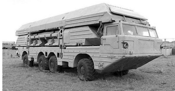
Рис. 2. Плавающая машина ПММ-1 с водоизмещающим способом обеспечения плавучести
