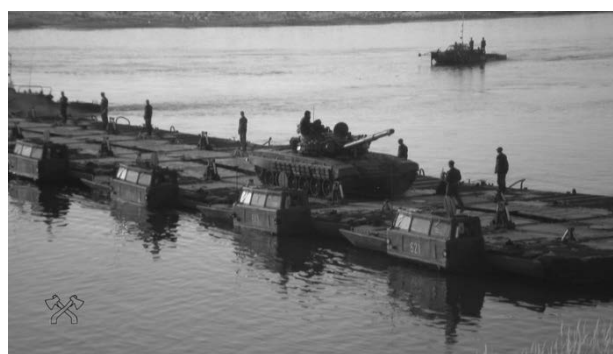
Рис. 5. Паромный мост, организованный колесной паромно-мостовой машиной ПММ-1
