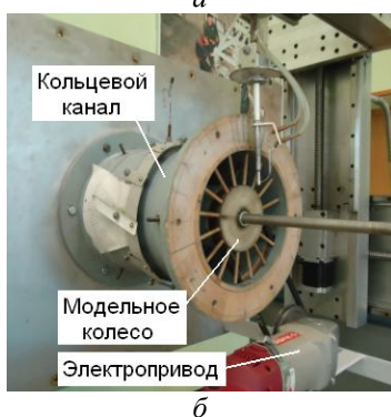
Рис. 5. Исследуемая система с модельным переходным каналом (а) и привод модельного колеса (б) (переходный канал снят)
