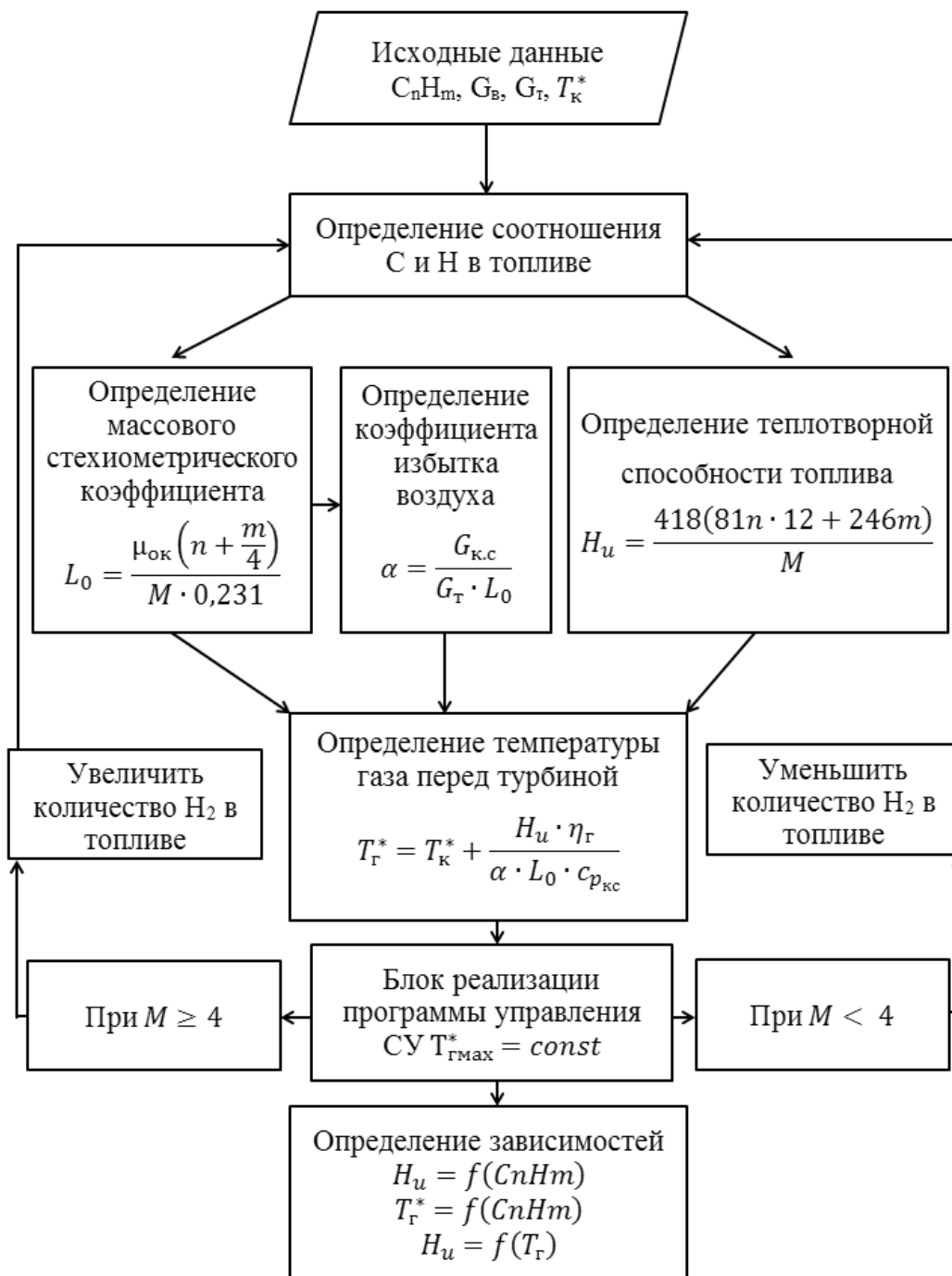
Рис. 3. Блок-схема методики расчета термогазодинамических характеристик водородосодержащего углеводородного топлива
