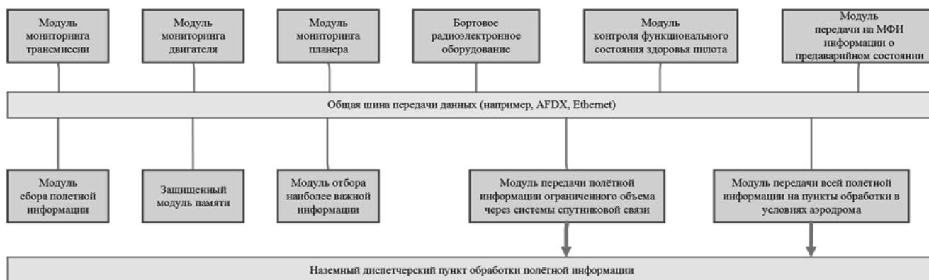
Рис. 1. Структурно-функциональная схема интегрированной системы диагностики и прогностики технического состояния летательного аппарата, включая подсистему контроля функционального состояния пилота
