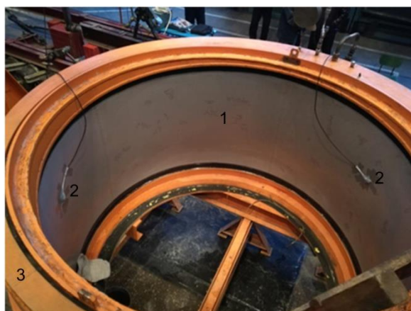
Рис. 3. Испытательный стенд и места установки датчиков акустической эмиссии из комплекта аппаратно-программного комплекса акустико-эмиссионного диагностирования «Эмиссия-4» на воздухозаборник самолета Ил-96-400М:
