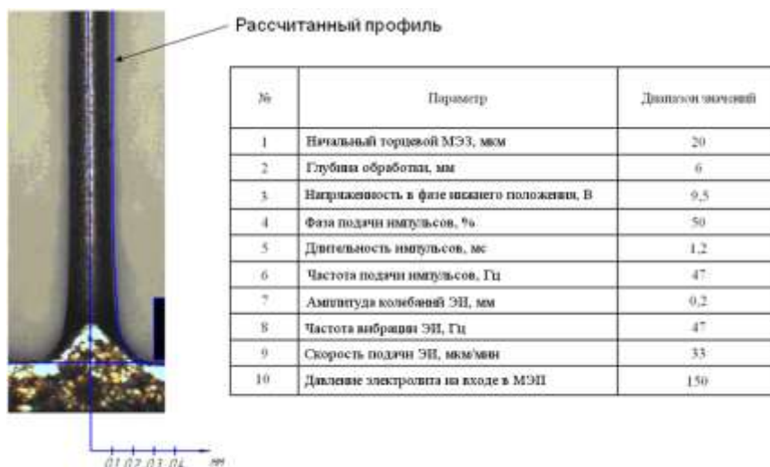
Рис. 7. Сравнение экспериментальной и расчетной формы щеточного элемента
