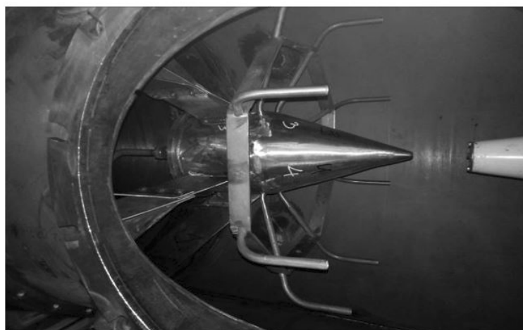
Рис. 2. Проведение испытаний ПД-14 по забросу вулканического пепла: а – размещение газогенератора ПД-14 на стенде; б – пылящая установка
