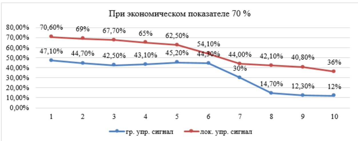
Рис. 9. График работы системы при экономическом показателе 70 %
