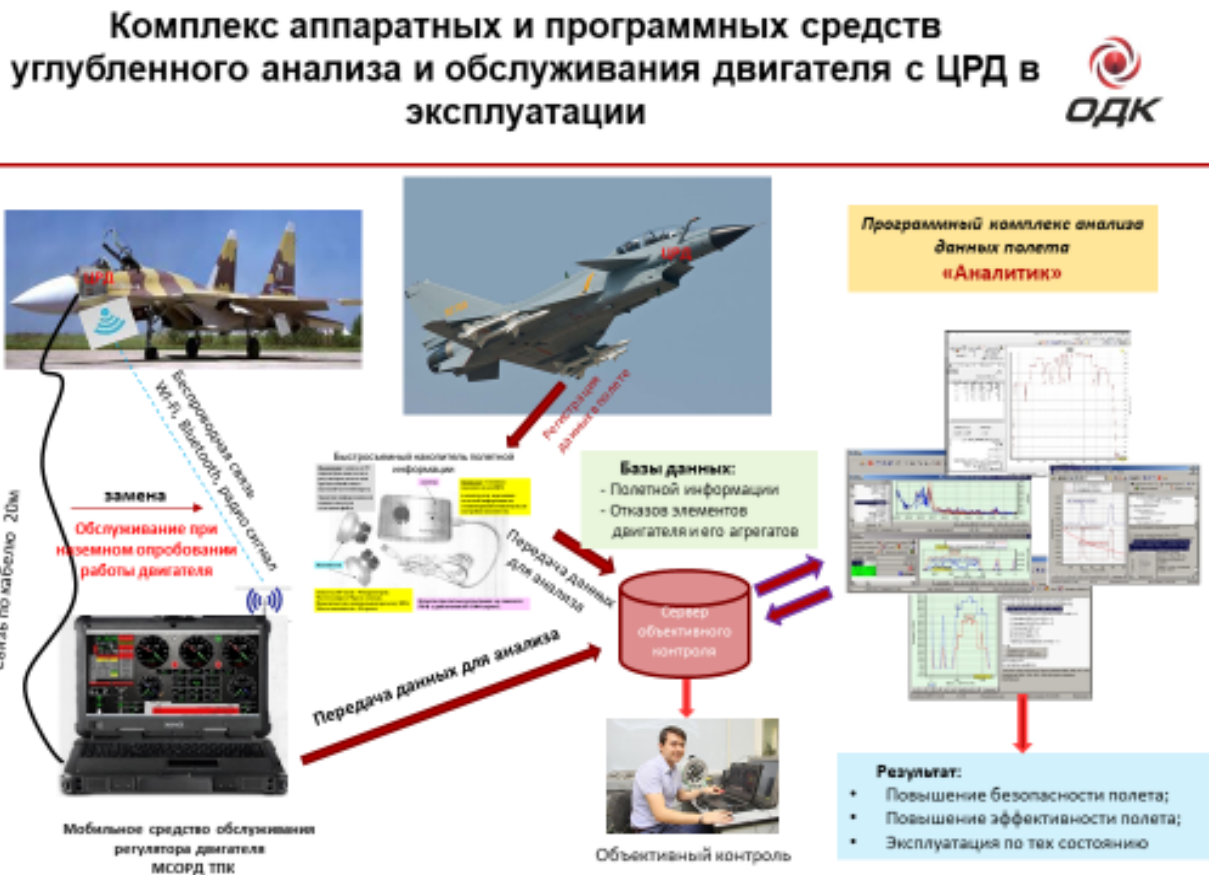
Рис. 1. Комплекс аппаратных и программных средств для углубленного анализа и мобильного обслуживания авиационного двигателя с цифровым регулятором в эксплуатации
