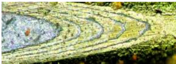
Рис. 1. Наклонный шлиф по входной кромке лопатки 2 ст. КНД из титанового сплава ВТ6 – многослойное покрытие системы (Ti–Ti 2 N–TiN)-n в результате КВИПО
