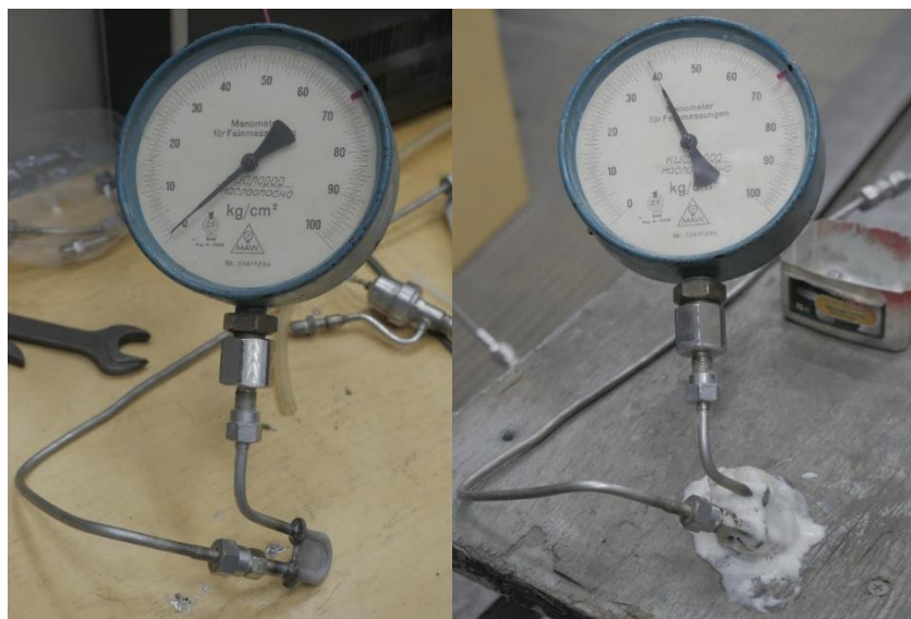
Рис. 15. Образец до и во время испытаний на герметичность
