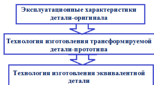
Рис. 2. Принцип реинжиниринга эксплуатационных свойств детали турбины ГТУ трансформацией технологии изготовления детали турбины ГТД в технологию изготовления эквивалентной детали
