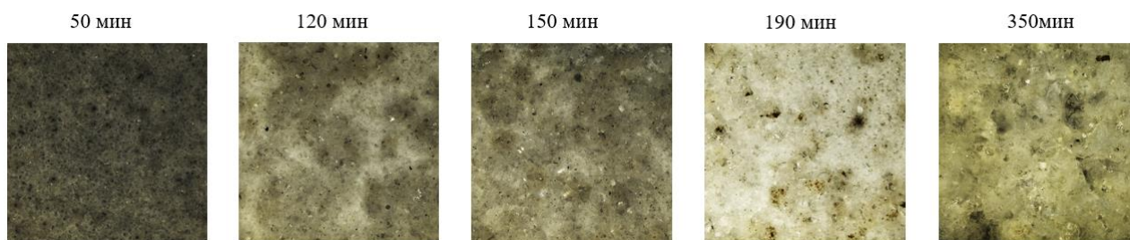
Рис. 5. Структура поверхностного слоя МДО покрытия на сплаве AlSi10Mg, полученном методом СЛС (20X).
