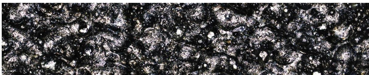
Рис. 1. Поверхность образцов из сплава AlSi10Mg, полученного методом СЛС (20X).
