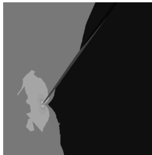
Рис. 8. Напряжения по Мизесу в области вершины трещины
