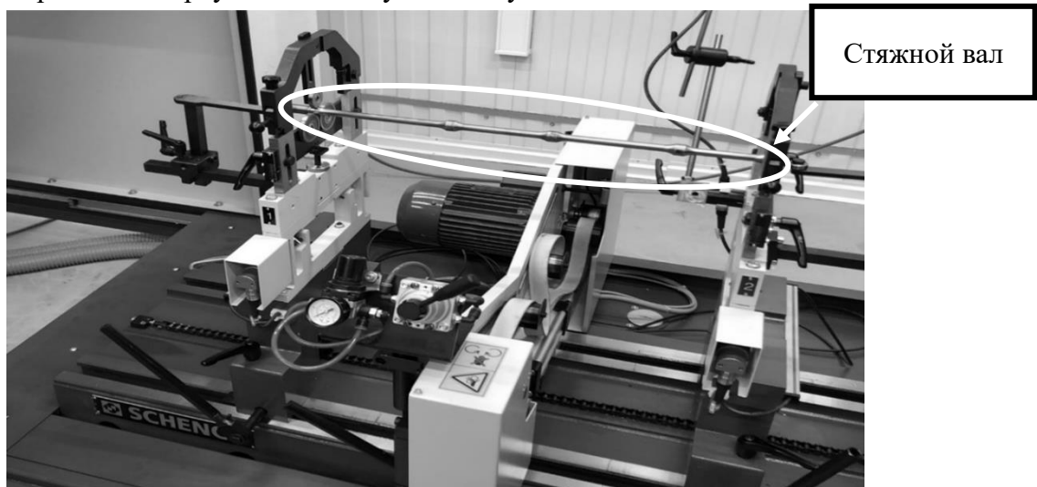
Рис. 3. Стяжной вал на балансировочном станке
